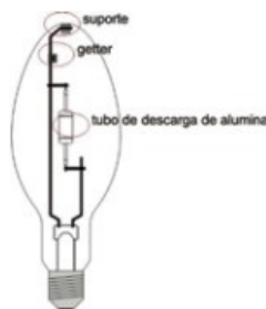
Figura 37- Mecanismo de funcionamento de lâmpada a vapor metálico com tubo cerâmico. Fonte: Lâmpadas e Leds – Portal o Setor Elétrico, Ed. 46 – Novembro de 2009
