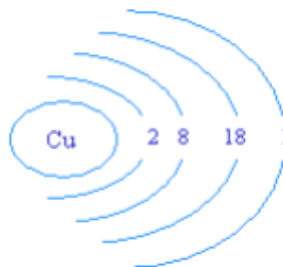
Figura 4.0- Exemplo de um material com condutor, cobre. Fonte: (MALVINO, 1987).
