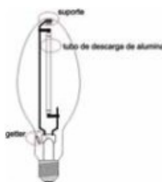
Figura 35- Mecanismo de funcionamento de lâmpada a vapor de sódio. Fonte: Lâmpadas e Leds – Portal o Setor Elétrico, Ed. 46 – Novembro de 2009
